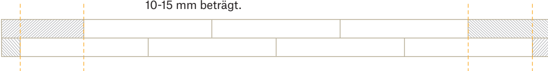
Abb. 11: Verkleben der ersten Reihen, mit Hilfslinien und Passstücken.
